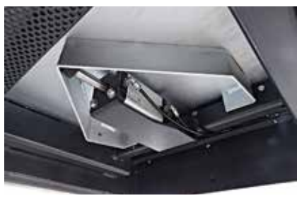
Bloccaggio e sbloccaggio pneumatico delle piastre oscillanti Pneumatic lock and unlock of the sliding plates
