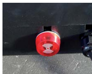
Protezione anti schiacciamento piedi "foot guard" device protection
